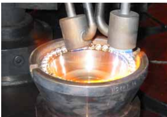
Verwärmen / Feuerpolieren von der Oberseite
