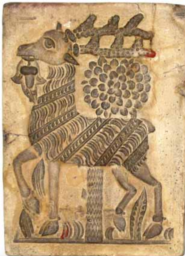
Die „ Patrize “ wurde in den Sand des Unterkastens der Gussform eingedrückt. Damit wurde der Hohlraum im
