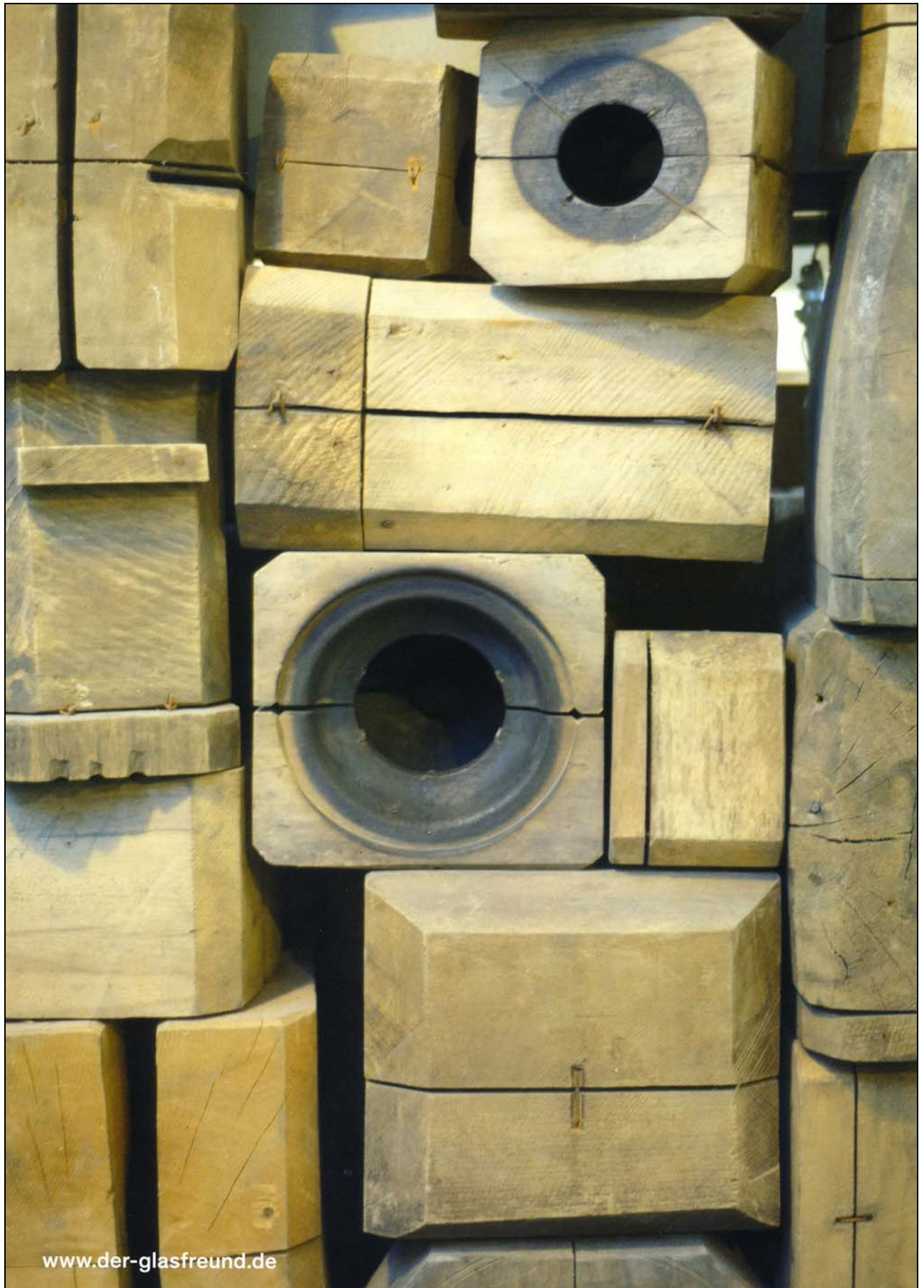
Abb. 2017-2/16-02; Einband Rückseite; der glasfreund, 22. Jahrgang - Februar 2017, Nummer 63 Holzmodell für form-geblasene Trinkgläser - Glasmuseum Frauenau; Photos: Wieland Kramer
