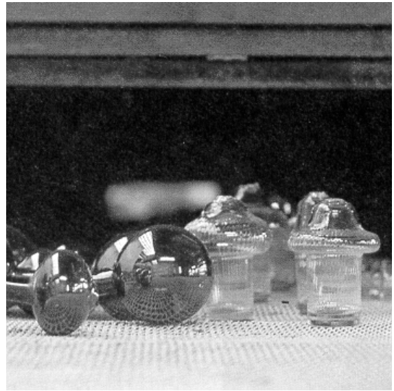
Abb. 01-99/74 Abbildung aus Schagemann 1988, In die Form geblasene Gefäße besitzen zunächst noch ihre Kappe
