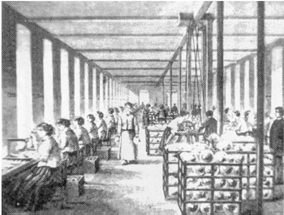
Abb. 1999-3/072 aus Stenger 1988, S. 235, Glashütte Troisfontaines „Découpage de boules“ Aufschneiden der Glaskugeln aus Fenne und Vallérysthal
