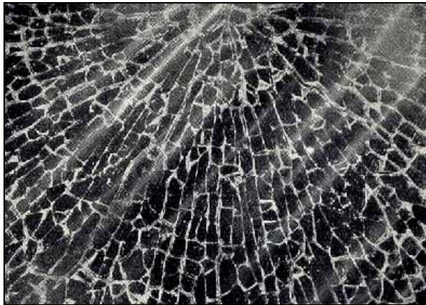
Abb. 2011-1/182 Bruchbild einer gehärteten Glasscheibe Sammlung Mauerhoff
