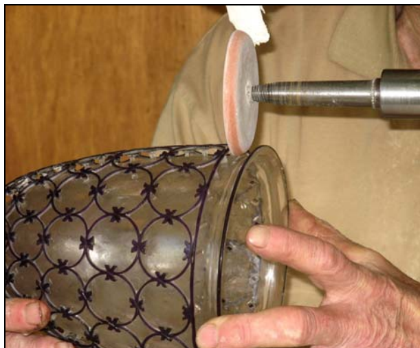
Abb. 2012-1/62-23 Schleifen des ausgeschweiften Randes eines Diatretgefäßes Foto J. Welzel
