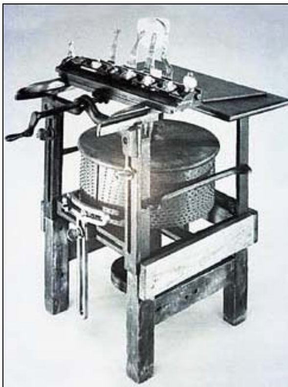
Guilochier-Maschine John Northwood 1861 [Гильеширная машина Дж. Нортвуда. 1861 год]
