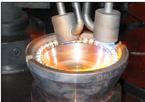
Verwärmen / Feuerpolieren von der Unterseite
