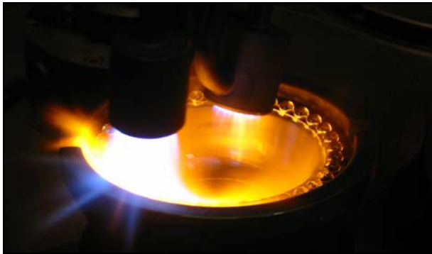
Verwärmen / Feuerpolieren von der Oberseite
