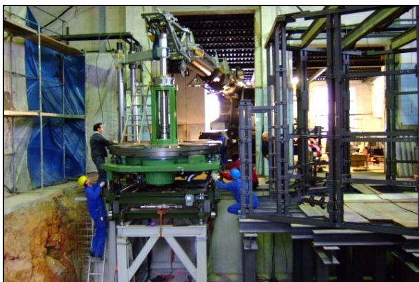
Abb. 2013-4/38-09 GLASAX: Montage der neuen Waltec-Presse (Foto A. Koitzsch)
