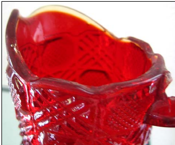
Abb. 2014-2/04-14 Gelber Rand der Öffnung des Kännchens aus Abb.12a. Am Kännchenrand ist das Selen ausgebrannt.
