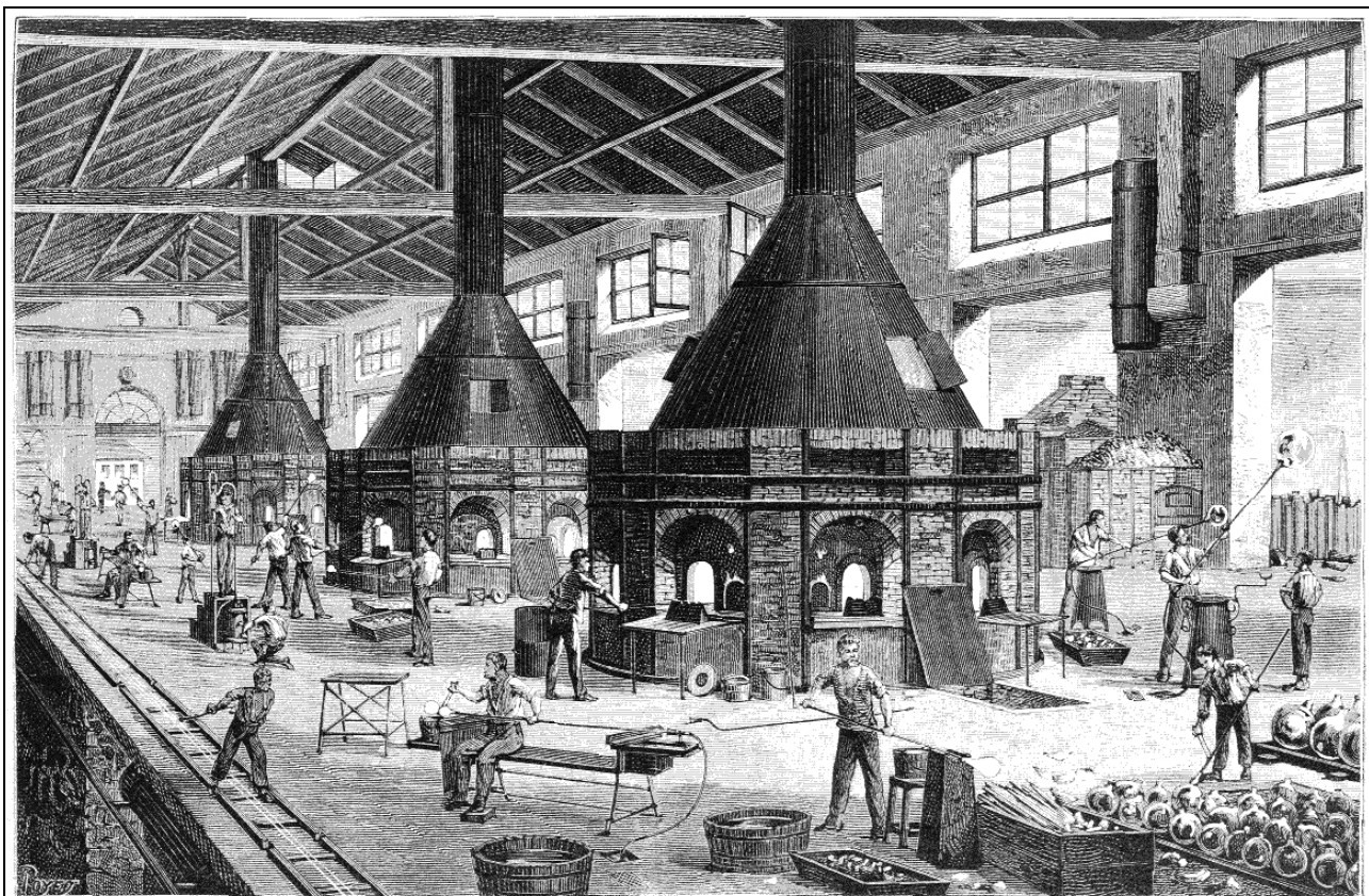
Fig. 4. — Vue d'ensemble de la verrerie de MM. Appert frères, montrant le travail du nouveau procédé de soufflage du verre par l'air comprimé.
